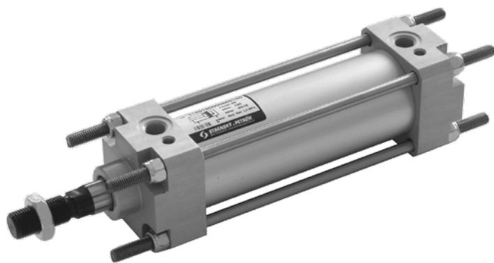
Ces vérins ont été conçus selon les spécifications du standard international CETOP. Ils intègrent un amortissement pneumatique réglable à l'avant et à l'arrière. Ils sont en standard prévus pour la détection magnétique. De nombreuses options et autres matériaux tant pour les composants (acier, inox, fibre de carbone) que pour les joints (basses et hautes températures, résistance chimique spécifique) sont disponibles sur demande.
